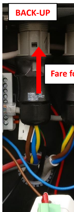
Figura 58 – Inserimento della spina installata sulla linea "EPS BACK-UP"
