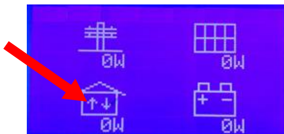
Figura 85 - Verifica della comunicazione attiva con il portale Aton
