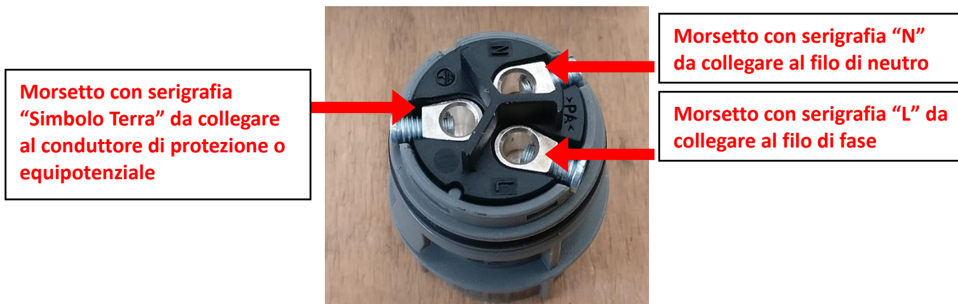
Figura 56 – Indicazioni di cablaggio spina linea elettrica “EPS BACK-UP”
