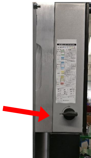
Figura 36 - Posizione in cui si deve trovare l'interruttore sul fianco sinistro dell'articolo ATM-xK-TL
