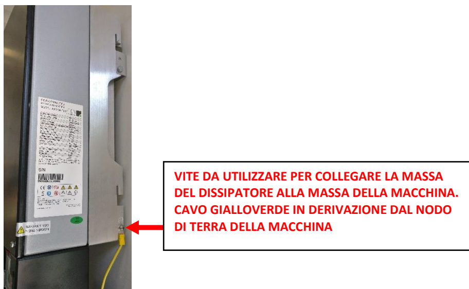
Figura 40 - Collegamento tra il nodo di terra della macchina e la massa del dissipatore
