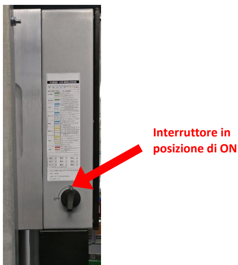
Figura 63 - Interruttore sul fianco sinistro dell'articolo ATM-xK-TL in posizione di ON
